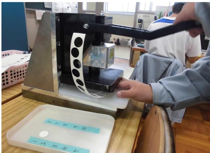
手工芸班では、小さなパーツを切り抜くことが多く、ハンドプレス機を使用することにより、だれでも型抜きをすることができます。
