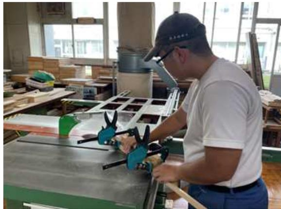
【角度を合わせて、トレーの部材を斜めに切断】 【トレー1に対して4枚の部材・8ヶ所の切断】
